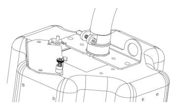
Figure 13: Clamping a conduit
