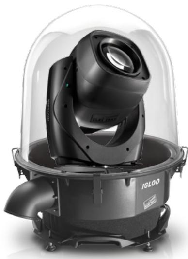
La base è ovviamente predisposta per tutti i collegamenti elettrici e di segnale, tutti protetti contro le intemperie. Poiché i proiettori generano molto calore, la base contiene anche i dispositivi di "condizionamento" e circolazione dell'aria, affinché all'interno della cupola permanga la temperatura ideale, anche in funzione di quella atmosferica esterna (IGLOO WL e ECO).
